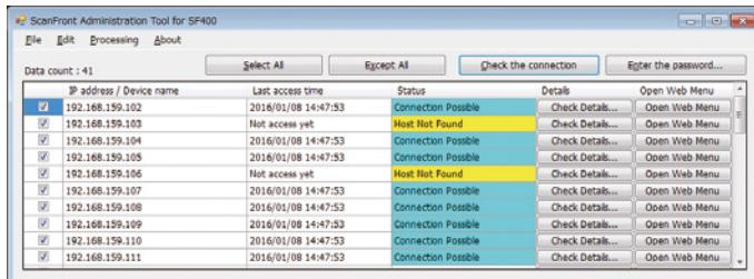
Softver s administrativnim alatima omogućuje vam upravljanje više ScanFront skenera istodobno. Možete provjeriti trenutačan status ScanFront skenera u mreži, konfigurirati postavke, upravljati korisnicima, izrađivati sigurnosne kopije i vraćati konfiguracijske podatke.
